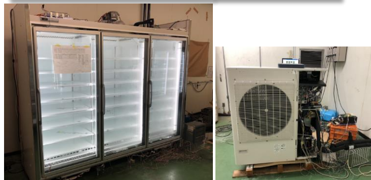
■ CO2冷凍機(2HP)による工場試験状況
